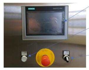
Über das Touchpanel wird die Anlage bedient. Außerdem können alle Einstellungen vorgenommen werden.
