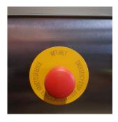
Bei Betätigung des Not- Haltschalters werden alle Aktoren sofort blockiert. Erst wenn der Not- Halt durch Ziehen entriegelt wird, kann der Fehler über das Fehlermenü quittiert werden. Danach ist ein neuer Abfüllprozess möglich.
