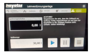
Zunächst kann eine Spülmenge eingestellt werden. (30-120l). Durch Betätigen des Start. Buttons wird das eingestellte Spülwasser über den Schlauch in den Rührbehälter geführt. Das Rührwerk wird zur Reinigung zugeschaltet, wenn der untere Grenzstandmelder bedeckt ist.
